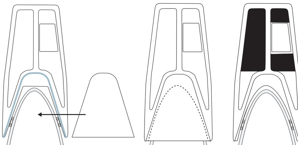
Montera täcksivan på peket. Såga ut efter förens form (använd kartong som mall vid behov). Fäst med sikaflex innanför kanten (ca 10 mm runtom). Smeta även sikaflex utanpå kanten och jämna till snyggt efteråt. Skruva sedan på Blacklineskivorna.
