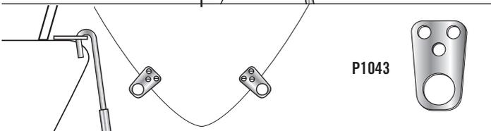
**ALTERNATIV 3:** Platta ögelfästen monteras direkt på skrovet. /
