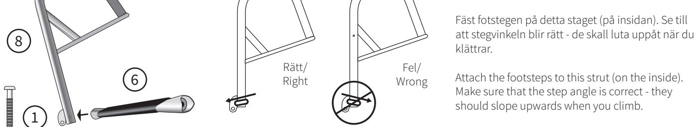
**OBS!** Använd fett på bulten så att den inte skär./ **NOTE!** Use grease on the bolt so that it does not cut.
